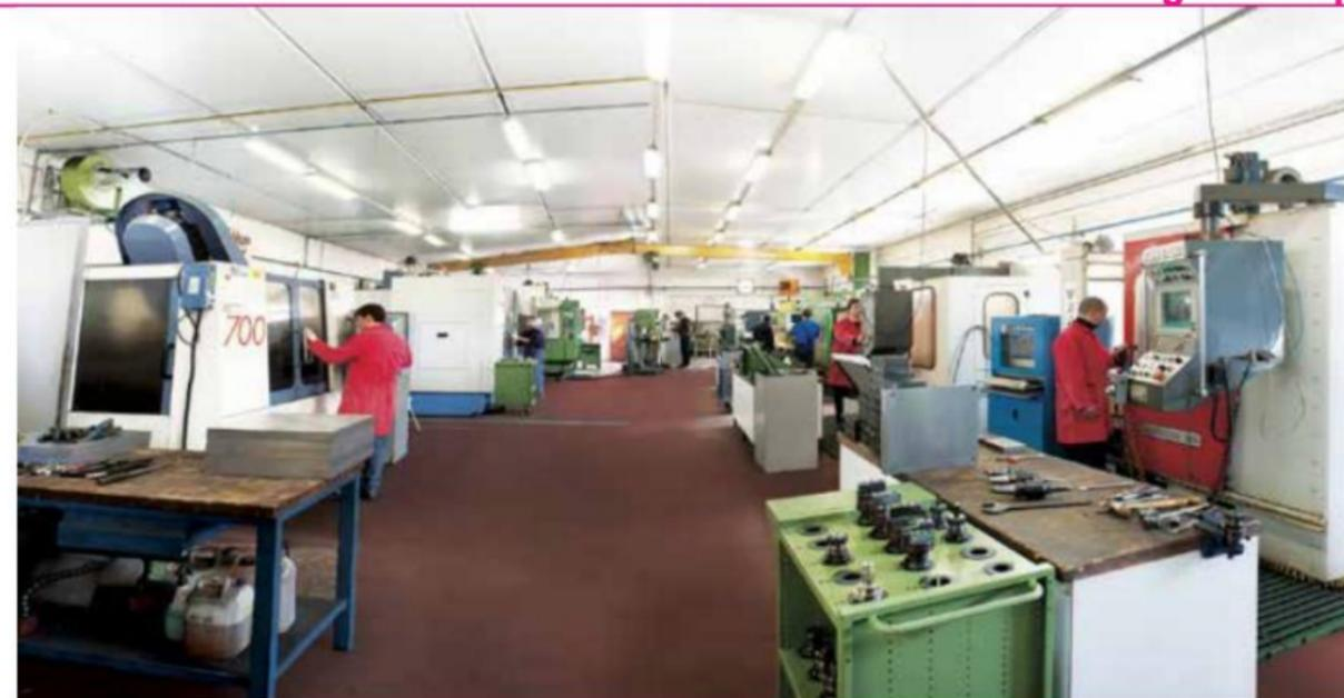
prire una gamma di stampi di varie misure fino a 1.500x750mm; ci sono poi un tornio a controllo numerico motorizzato e uno tradizionale, un'elettroerosione a tuffo, due rettifiche tangenziali e varie attrezzature di complemento che permettono l'esecuzione e l'assemblaggio di tutti i componenti degli stampi. Inoltre, la progettazione viene realizzata dall'ufficio tecnico tramite software 3D di ultima generazione, che sono ormai parte integrante del lavoro dello stampista.
