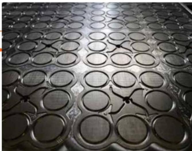
Dettaglio stampo iniezione multi-cavità 16 ugelli per OR in EPDM.
